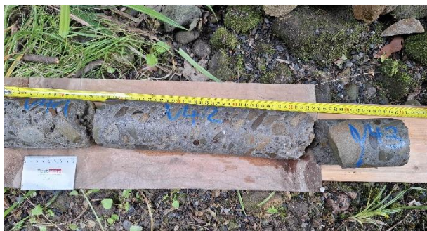
Pohled na strukturu betonu základu.
