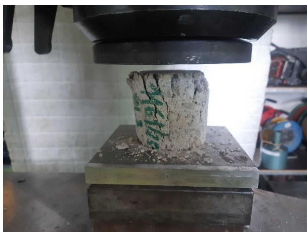
Krychelná pevnost ložné malty byla naměřena 9,3 MPa.
