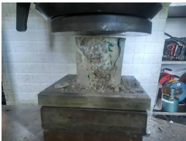
Pohled na porušený vzorek při hodnotě krychelné pevnosti 21,3 MPa.
