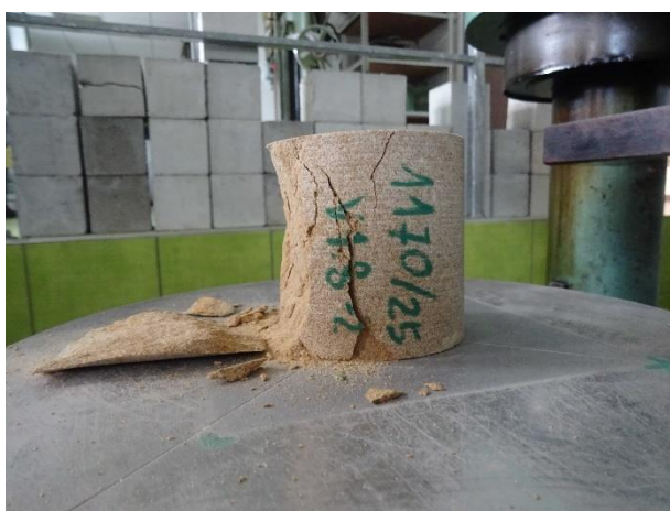
Pohled na porušený vzorek při hodnotě krychelné pevnosti 41,2 MPa.
