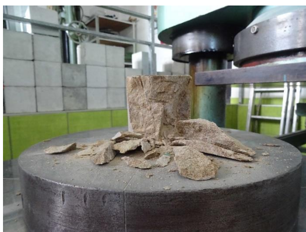
Pohled na porušený vzorek při hodnotě krychelné pevnosti 76,0 MPa.
