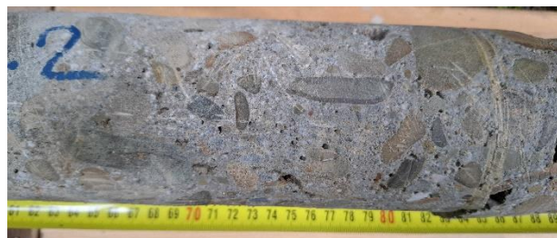
Detailní pohled na strukturu betonu s rovnoměrně rozloženým kamenivem.
