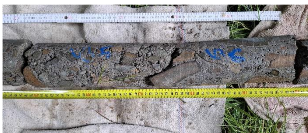
150-200 cm beton opěry se zvýšenou pórovitostí,
