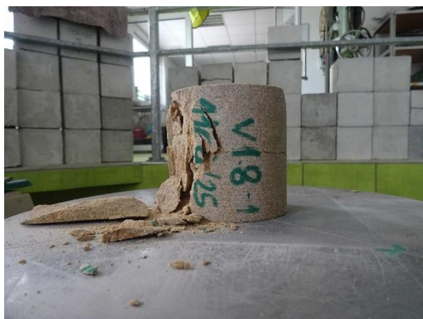
Pohled na porušený vzorek při hodnotě krychelné pevnosti 45,4 MPa.
