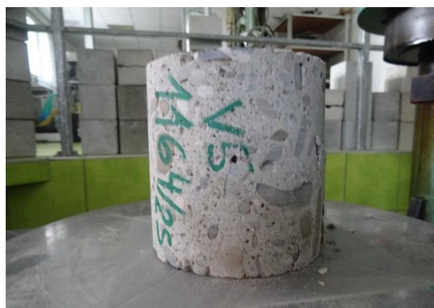
Pohled na porušený vzorek při hodnotě krychelné pevnosti 34,5 MPa.
