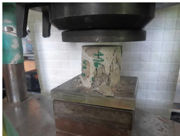
Pohled na porušený vzorek při hodnotě krychelné pevnosti 23,5 MPa.
