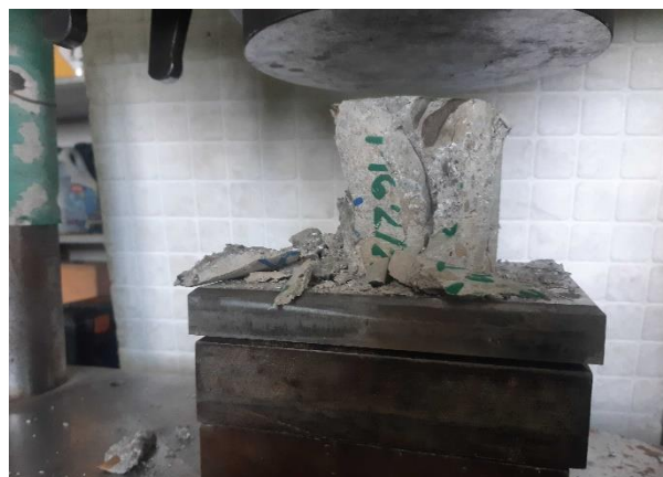
Pohled na porušený vzorek při hodnotě krychelné pevnosti 22,1 MPa.
