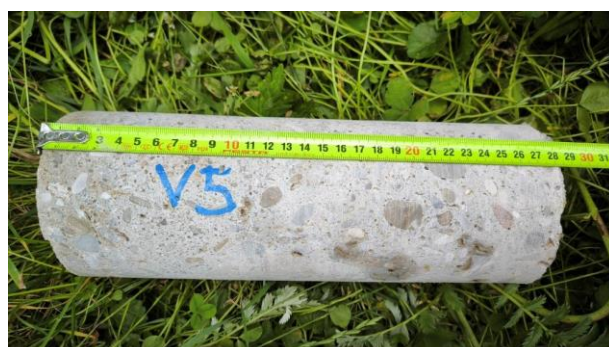
Pohled na strukturu betonu klenby, kamenivo říční předrcené rovnoměrně rozložené bez pórů, hutný dobrý stav,
