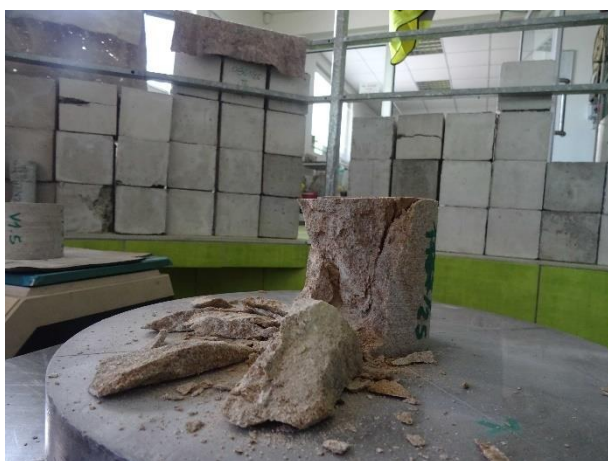
Pohled na porušený vzorek při hodnotě krychelné pevnosti 72,8 MPa.
